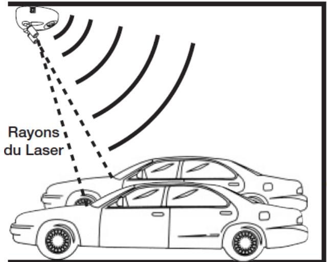
5. Lorsqu'une ou l'autre de vos voitures entre dans le garage en premier, le détecteur de mouvement allume les deux lasers. Avancez jusqu'à ce que le laser que vous avez ajusté pour votre véhicule éclaire le point de repère prédéterminé, indiquant que vous êtes stationné dans la bonne position. Les deux lasers s'éteindront automatiquement après que vous aurez stationné.
