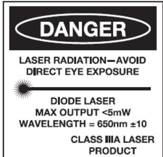
AVOID EXPOSURE, LASER RADIATION IS EMITTED FROM THE APERTURE.
